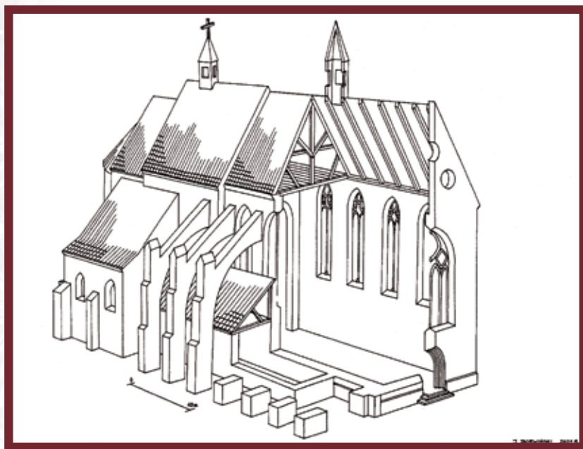
Ryc. 44. Rekonstrukcja kościoła klasztornego z okresu jego zabezpieczenia przed osiadaniem z nową fasadą zachodnią i przyporami łukowymi, rys. J. Borwiński
